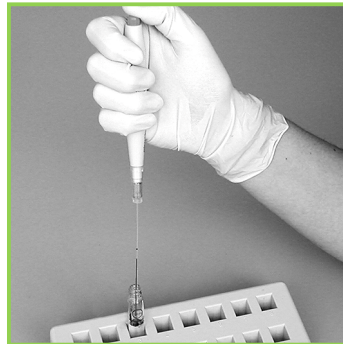
2. Probe mit Mikropipetter ausstoßen
