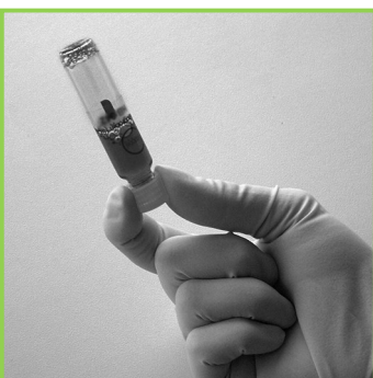
7. Küvette mehrmals über Kopf schwenken
