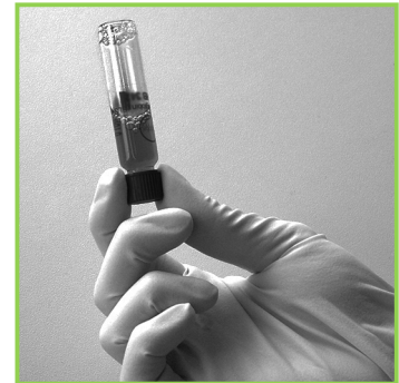
3. Verschlusskappe wieder aufschrauben Küvette mehrmals über Kopf schwenken
