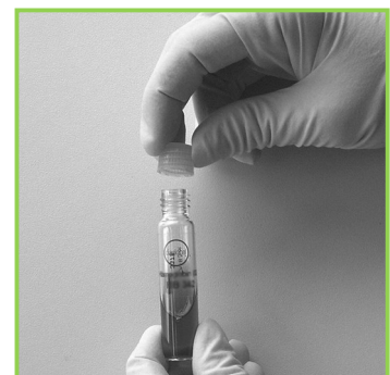
6. Verschlusskappe gegen Startkappe austauschen
