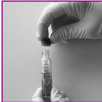
**2.** Kontrollkappe auf eine Küvette des zu prüfenden Tests aufschrauben
