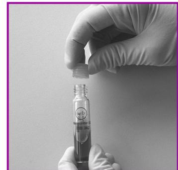
**6.** Kontrollkappe gegen Startkappe des zu prüfenden Tests austauschen
