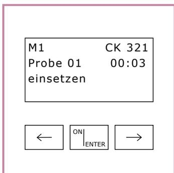
**7.** Bei Aufforderung erste Küvette zur Messung **M1** ins Gerät einsetzen
