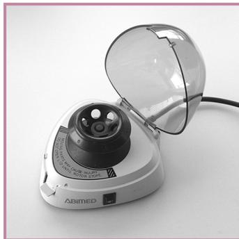
**2.** Reaktionsgefäße „R“ mit der Kapillare in die Zentrifuge stellen 1 Minute zentrifugieren
